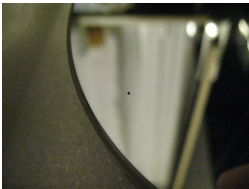
Figura 1 : Il piccolo granello di vernice nera depositata sullo specchio
