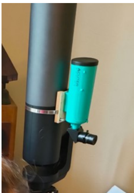
Figura 12: cercatore affrancato a Unistellar eVscope eQuinox (foto gruppo Facebook eVscope & eQuinox Users Global, tutti i diritti sono riservati)
