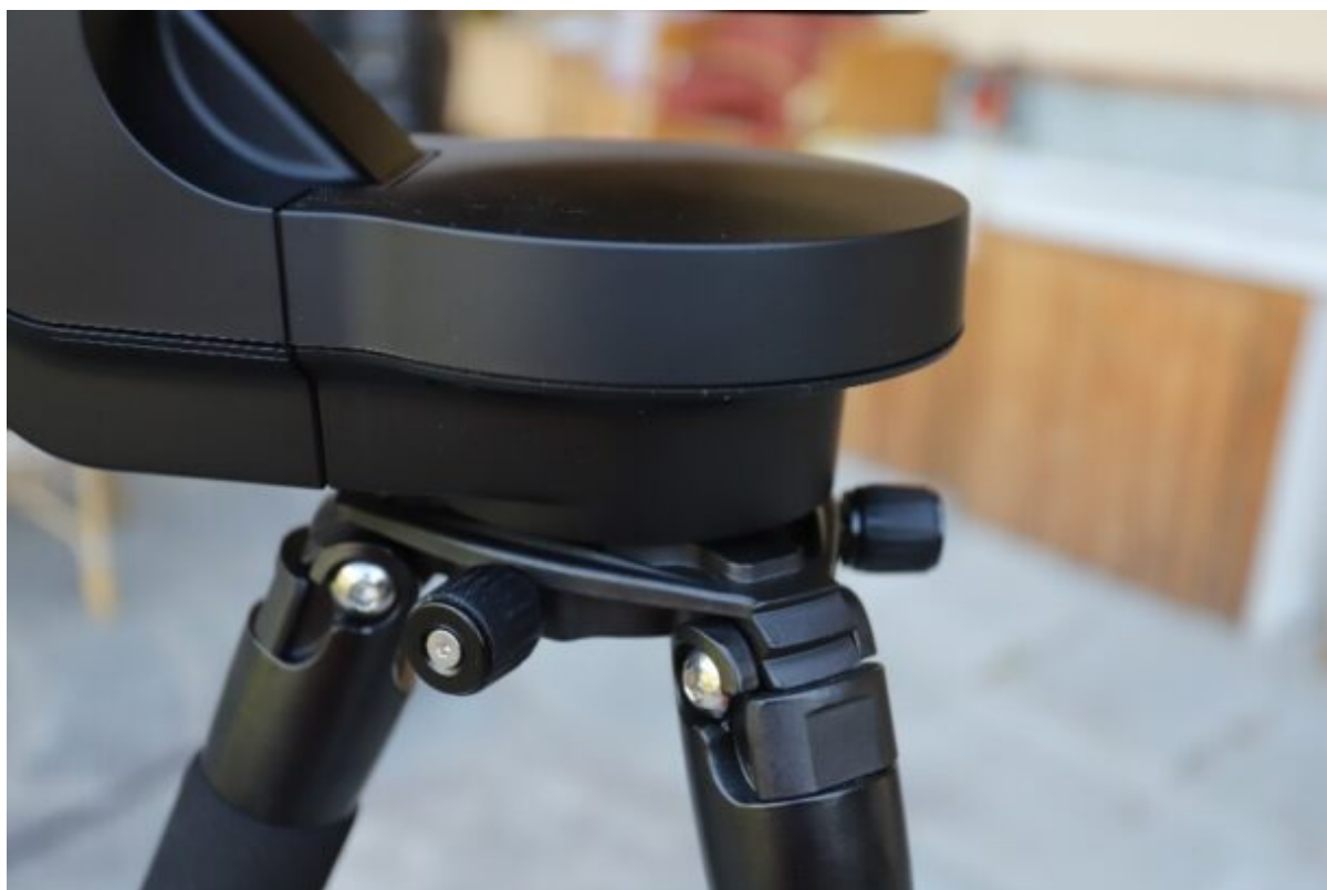
Figura 10: le due manopole di fissaggio del sistema telescopio-montatura con il treppiede.
