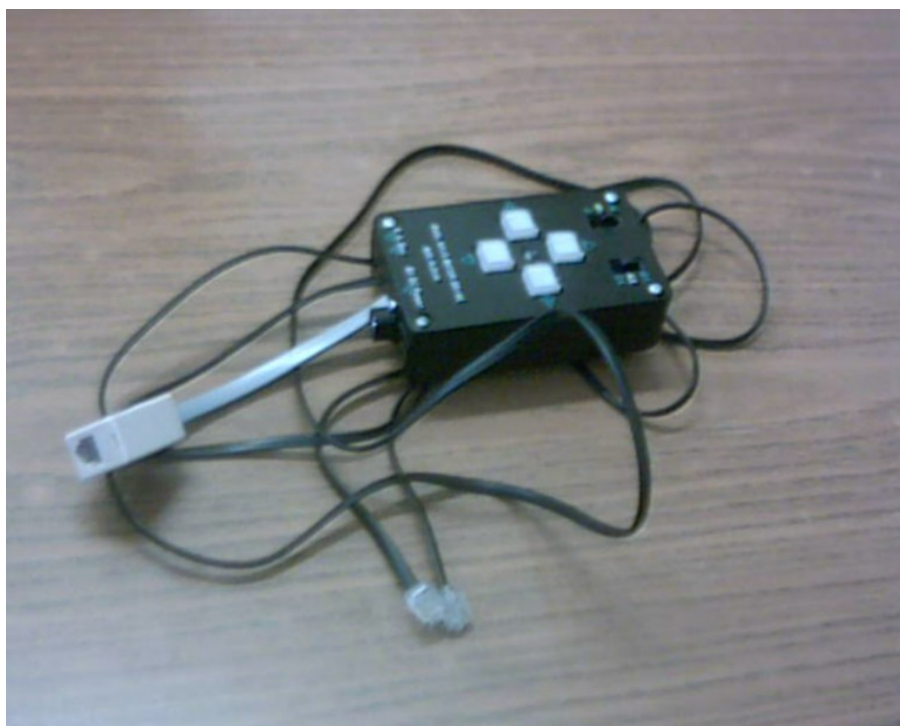
Figura 2: porta autoguida per montatura EQ.3.2
