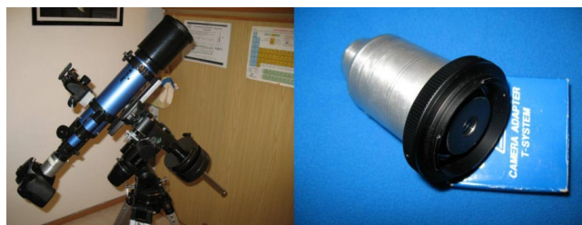
Configurazione per riprese in proiezione d'oculare
