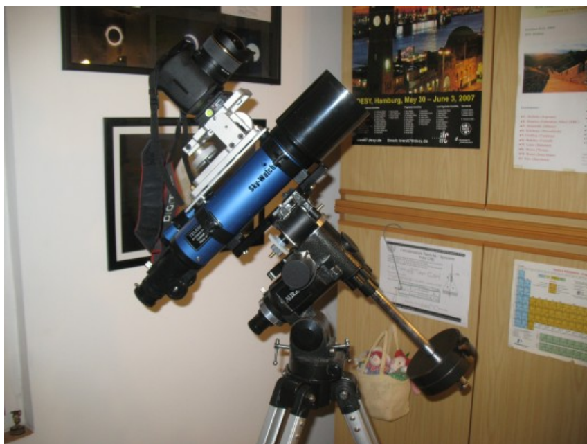
Sistema per fotografia in parallelo:
