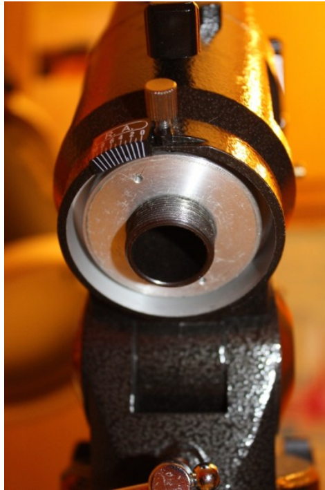
Figura 7: il disco di alluminio che "chiude" l'asse A.R.
