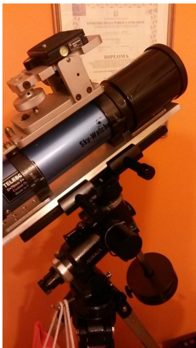
Figura 3: adattatore Vixen - Losmandy per montatura EQ.3.2
