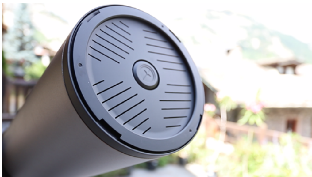
Figura 14: la maschera di Bahtinov montata su Unistellar eVscope eQuinox.
