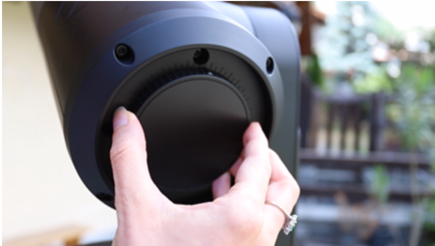
Figura 13: ghiera di messa a fuoco di Unistellar eVscope eQuinox
