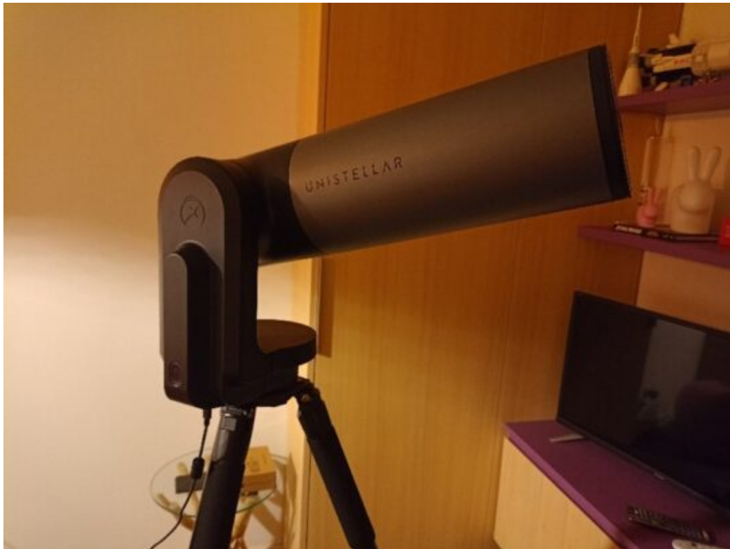
Figura 6: Unistellar eVscope eQuinox bloccato nella posizione corrente al completo esaurimento della batteria. Nel caso in esame non era più possibile smontare lo strumento in sicurezza richiedendo l'utilizzo di un alimentatore esterno ed un tempo sufficiente per raggiungere uno stato di carica minimo delle batterie interne.
