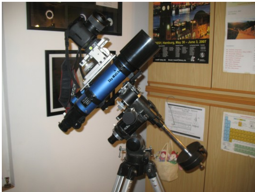
Sistema per fotografia in parallelo: telescopio rifrattore acromatico SkyWatcher 70 mm f/7.1 + testa Geoptik
