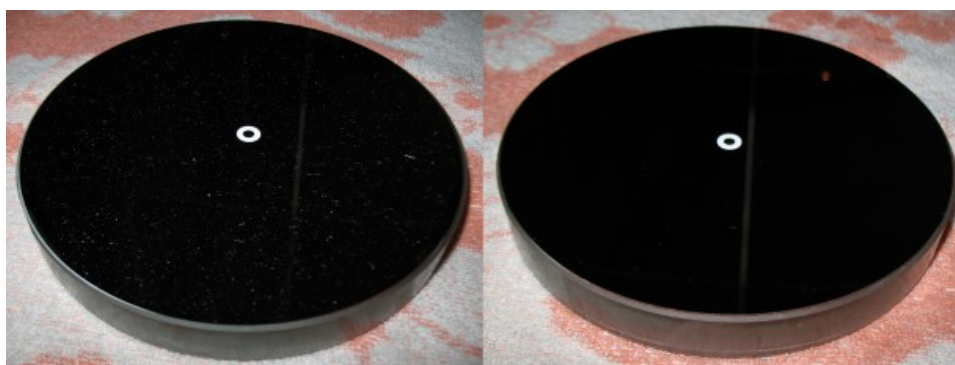
Risultato dell'operazione di pulizia dello specchio primario di un riflettore Newton 150 mm f/5
