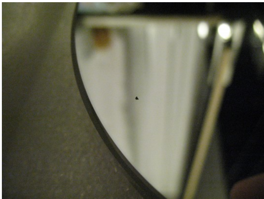
Figura 1 : Il piccolo granello di vernice nera depositata sullo specchio primario
