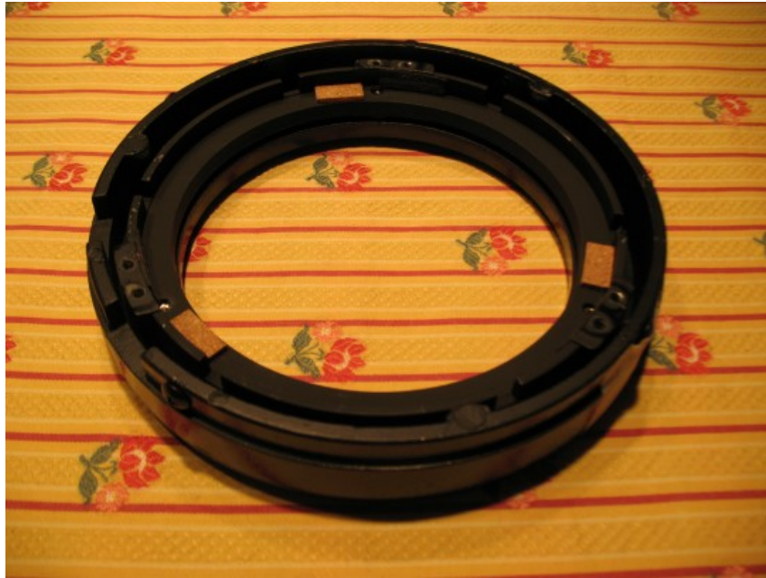
Figura 2 : cella di sostegno dello specchio primario. Ben visibili sono i tre spessori di sughero.
