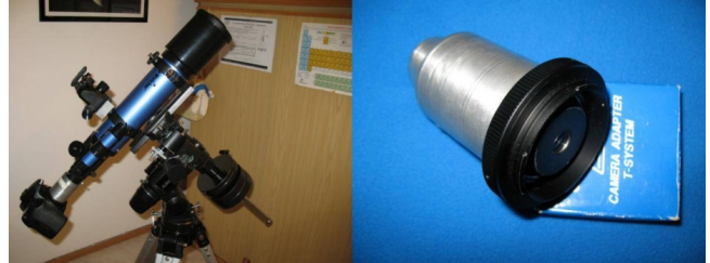
Configurazione per riprese in proiezione d'oculare
