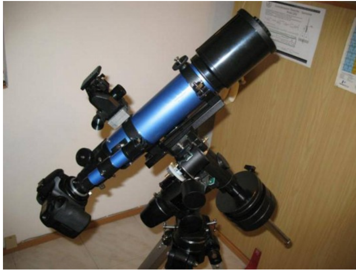
Figura 4.2: setup in configurazione "astrofotografia a fuoco diretto".
