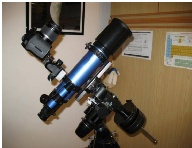
Figura 3.6: Setup in configurazione “astrofotografia in parallelo”.
