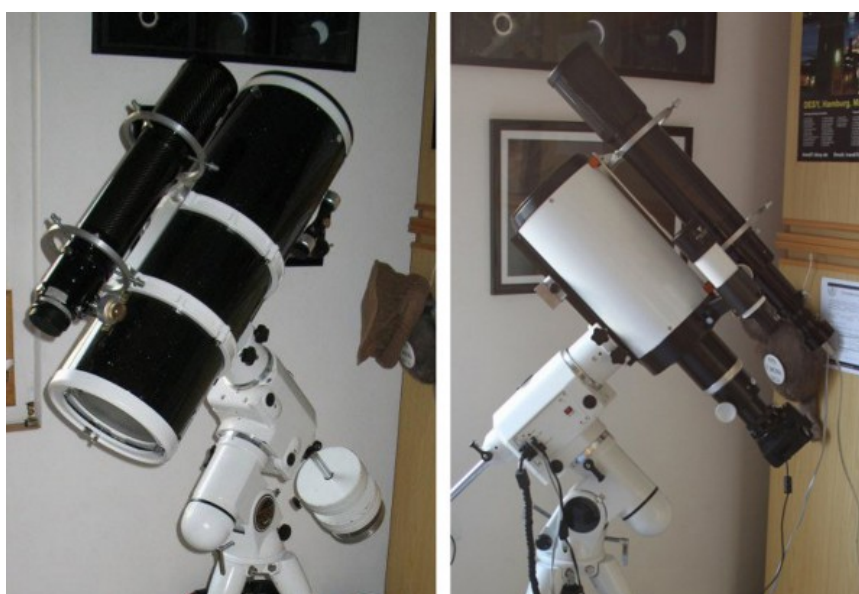
Figura 3.4: A sinistra esempio di telescopio riflettore Newton. A destra un esempio di telescopio Ritchey-Chrétien.
