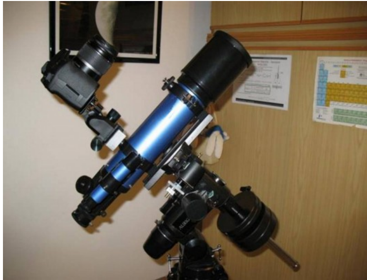
Figura 3.6: Setup in configurazione “astrofotografia in parallelo”.
