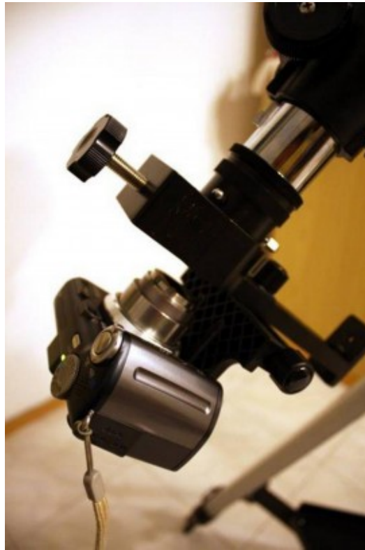
Figura 4.1: setup in configurazione "astrofotografia afocale".
