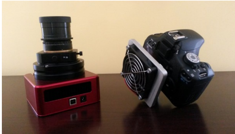
Figura 3.10: A sinistra una CCD astronomica ATIK 383L+. A destra una Canon EOS 500D con sistema di raffreddamento ad aria e “modifica Baader”.
