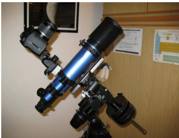
Figura 3.6: Setup in configurazione “astrofotografia in parallelo”.
