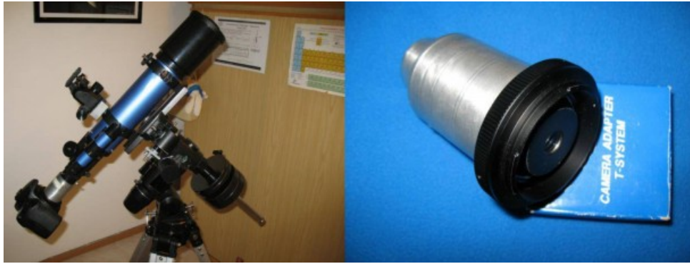
Figura 4.3: setup in configurazione “astrofotografia a fuoco indiretto”.
