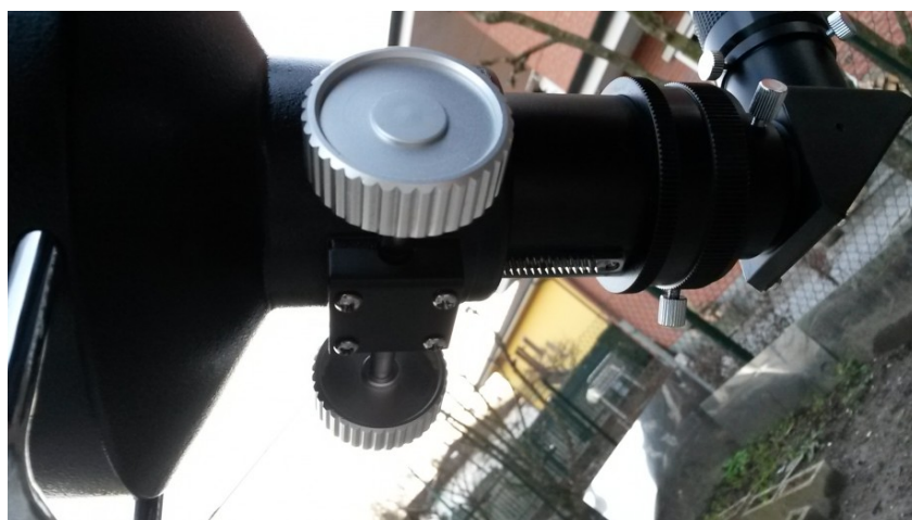
Figura 2: le quattro viti di regolazione del foccheggiatore
