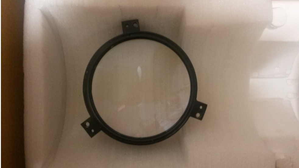
Figura 3: l'ottica del rifrattore smontata dalla sua cella.
