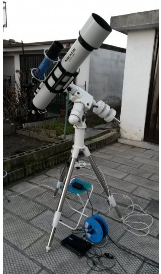
Figura 1: il rifrattore acromatico MEADE LX75 EMC con anelli e telescopio di guida.
