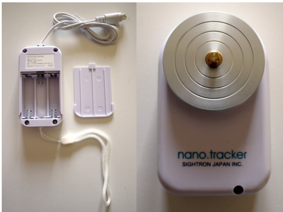
Figura 2: il telecomando di controllo a sinistra e l'astroinseguitore a destra.
