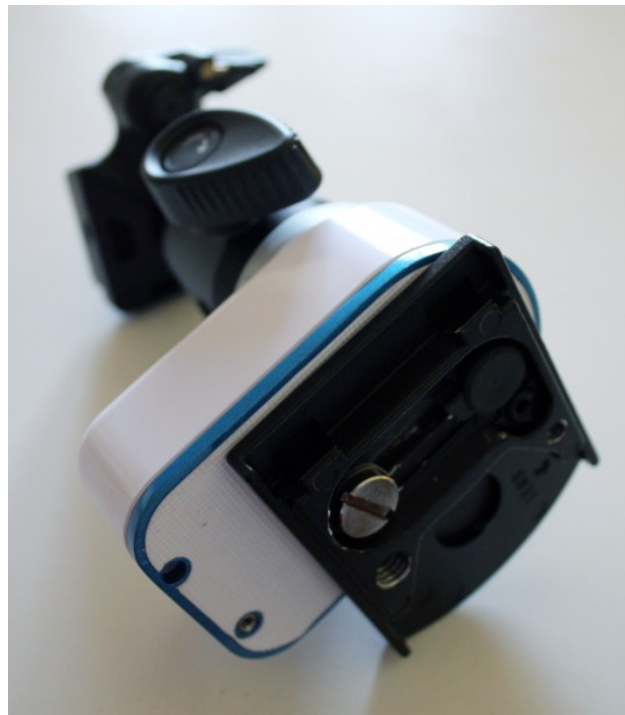
Figura 3: l'attacco tra l'astroinseguitore e la testa di regolazione dell'asse polare. In figura si vede anche la rondella descritta nel testo.
