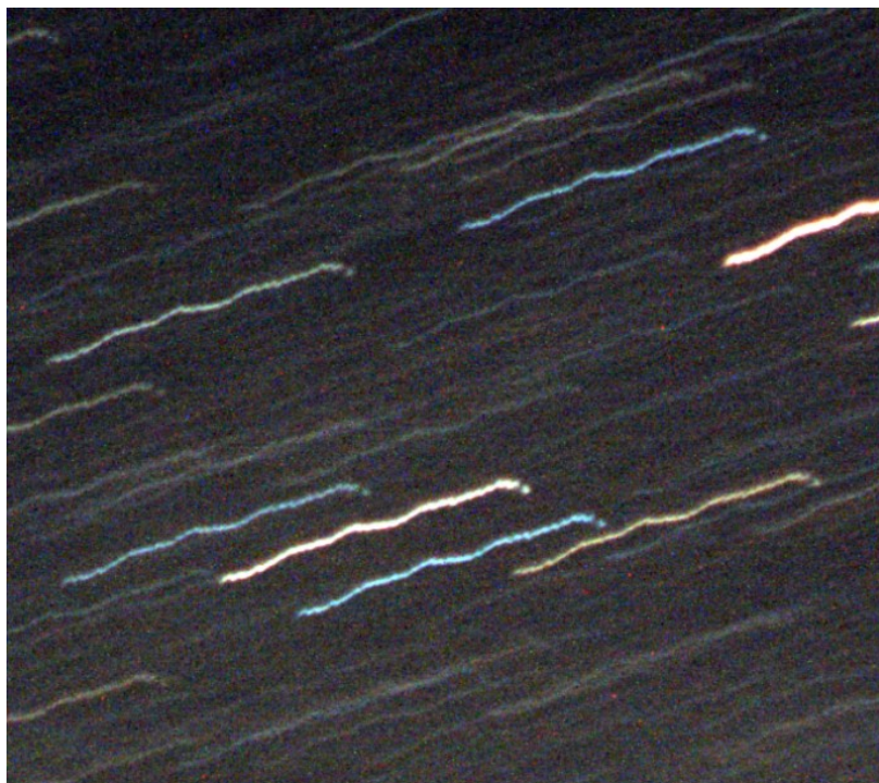
Figura 7: zoom delle tracce dovute al non perfetto inseguimento del nano.tracker in 16 minuti di posa. Si può osservare l'errore periodico del sistema.
