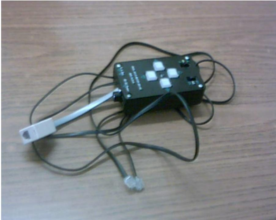
Figura 2: porta autoguida per montatura EQ.3.2
