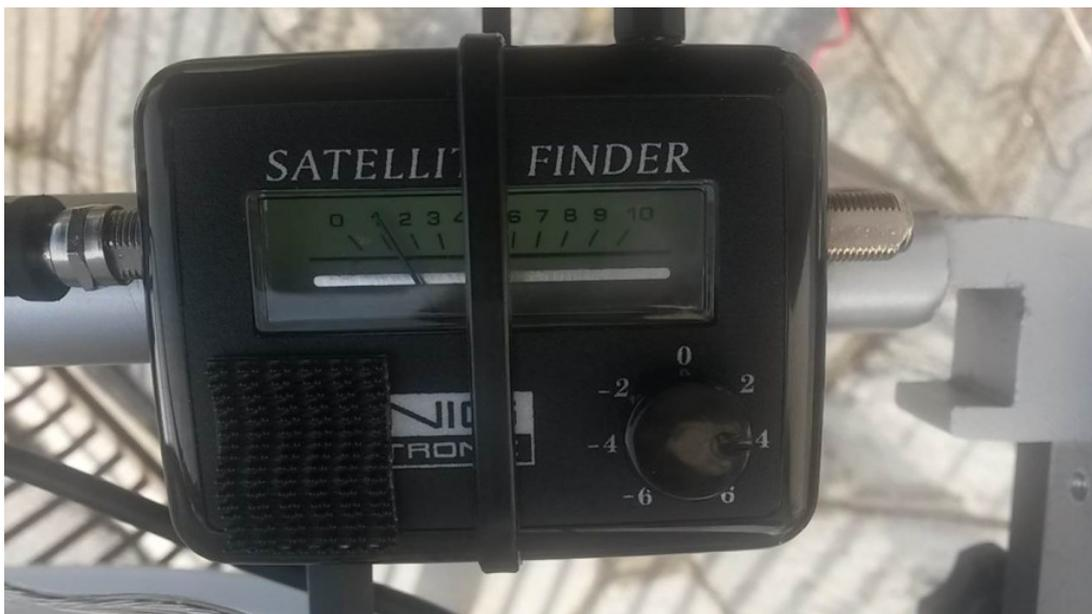
Figura 2: l'asta graduata (da 1 a 10) dell'intensità del segnale
