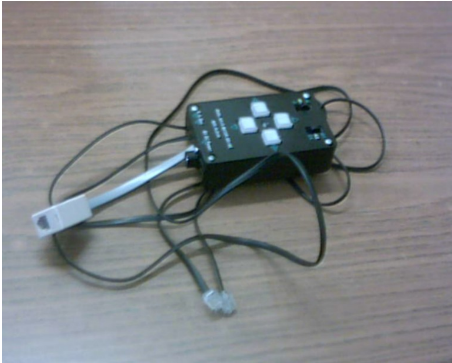
Figura 2: porta autoguida per montatura EQ.3.2
