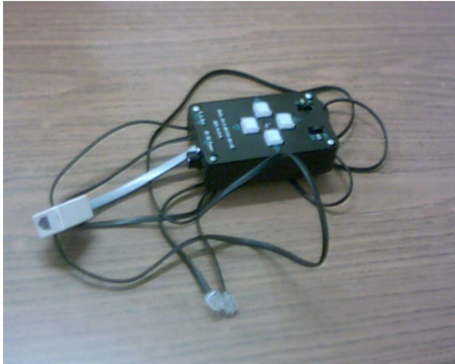
Figura 2: porta autoguida per montatura EQ.3.2
