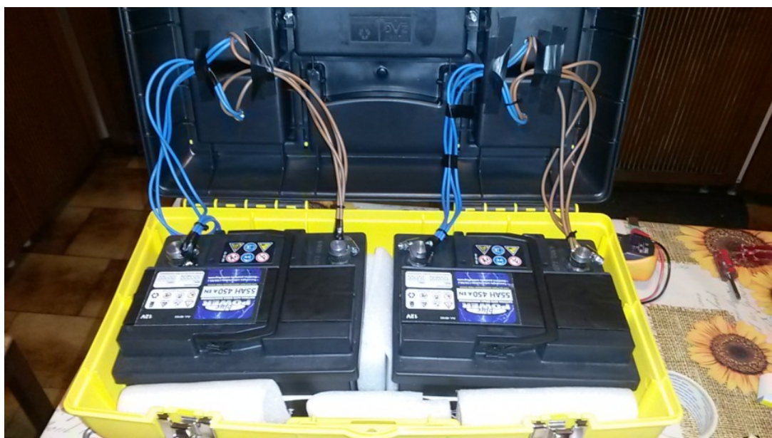
Figura 4: connessioni con la/le batteria/e. Ricordatevi di fissare le batterie nella cassetta degli attrezzi.
