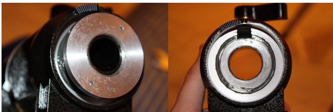
Figura 8: rimozione del disco di blocco dell'asse di ascensione retta.
