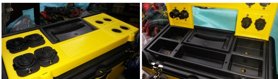
Figura 2: a sinistra l'installazione delle porte accendisigaro, a destra i fori passanti che permettono di collegare le porte alla batteria
