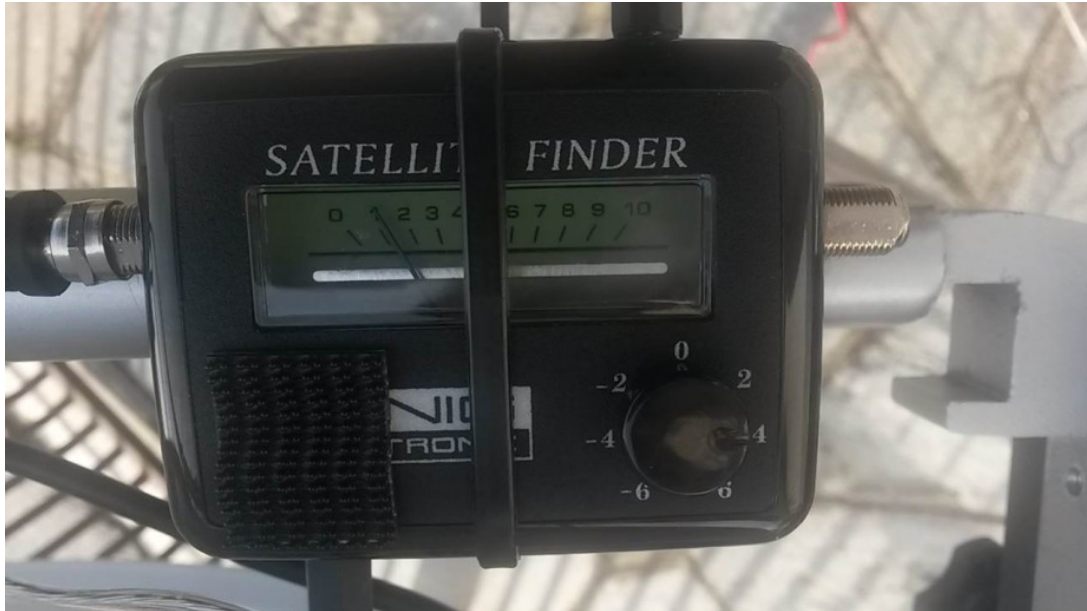
Figura 2: l'asta graduata (da 1 a 10) dell'intensità del segnale
