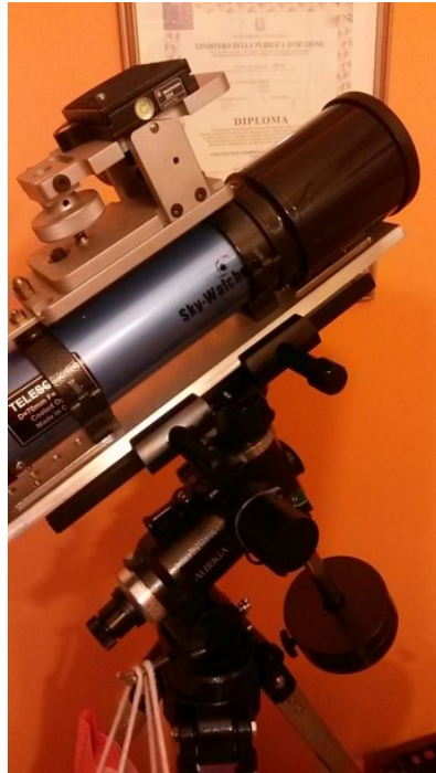
Figura 3: adattatore Vixen - Losmandy per montatura EQ.3.2
