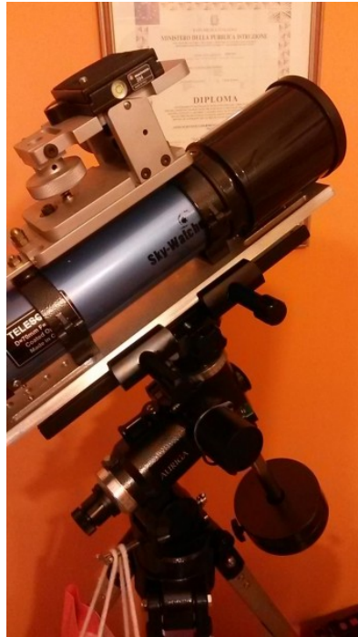
Figura 3: adattatore Vixen - Losmandy per montatura EQ.3.2
