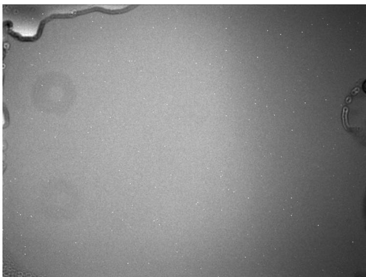
Figura 5: Flat field frame effettuato con CCD ATIK 383L+ monocromatica, filtro luminanza L Astronomik, 15 secondi di posa in bin 7x7.
