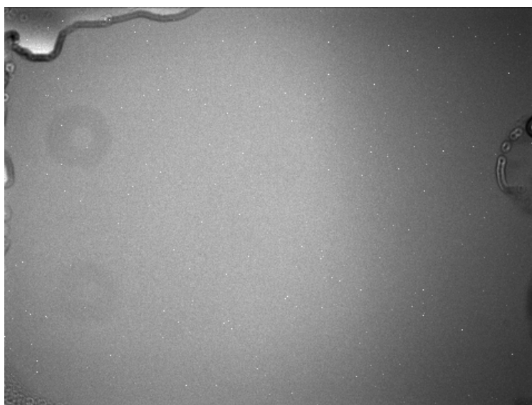
Figura 5: Flat field frame effettuato con CCD ATIK 383L+ monocromatica, filtro luminanza L Astronomik, 15 secondi di posa in bin 7x7.
