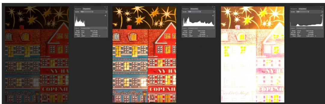
Figura 4: Da sinistra a destra una foto sottoesposta, correttamente esposta e sovraesposta con i relativi istogrammi.
