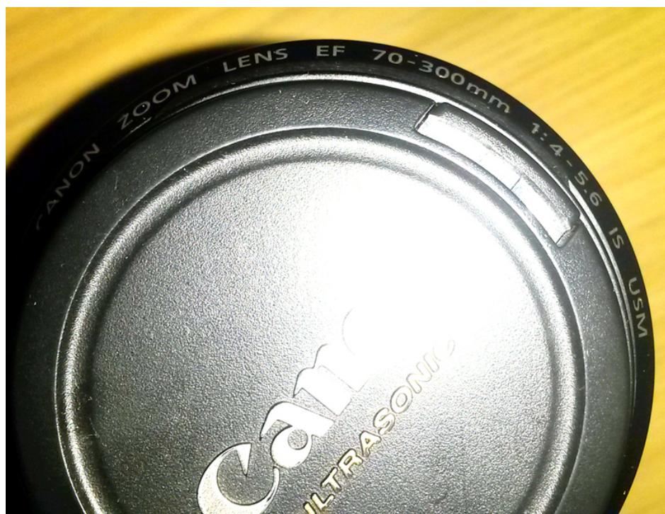
Figura 3: specifiche di un obiettivo fotografico. Nell'esempio: zoom con focale variabile da 70mm a 300mm. Diaframma a tutta apertura pari a f/4 se utilizzato a 70mm di focale, f/5.6 se utilizzato a 300mm.
