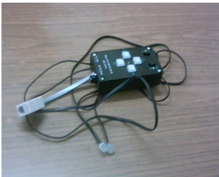
Figura 2: porta autoguida per montatura EQ.3.2
