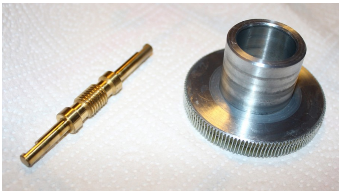
Figura 9: vite senza fine e corona dell'asse di ascensione retta ripuliti dal grasso originale
