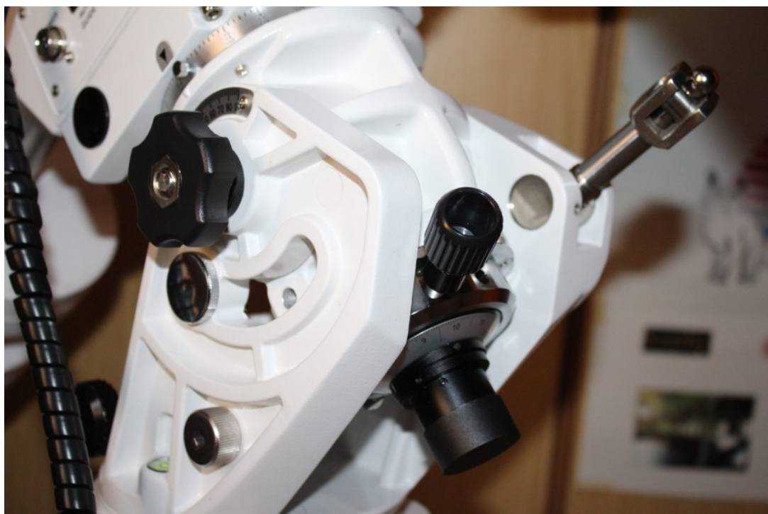
Figura 1: il mirino polare della montatura equatoriale alla tedesca SkyWatcher AZ-EQ6 GT
