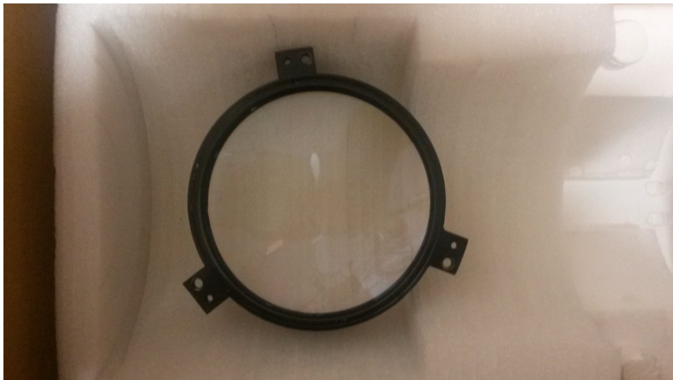
Figura 3: l'ottica del rifrattore smontata dalla sua cella.
