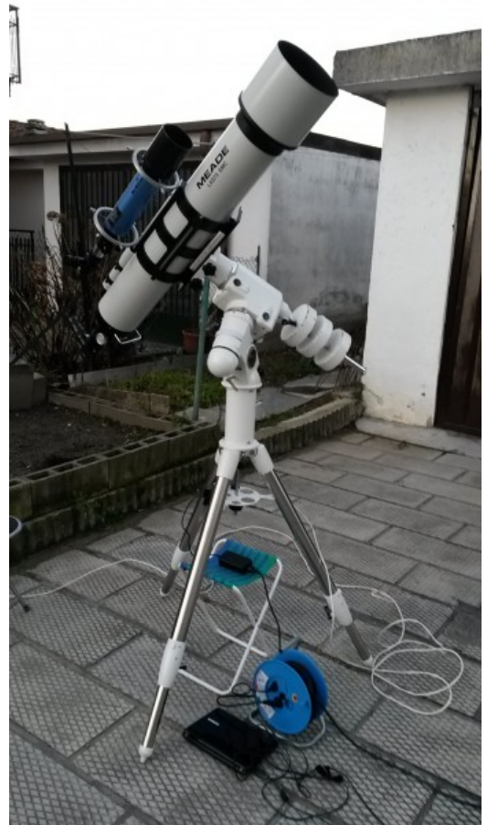
Figura 1: il rifrattore acromatico MEADE LXD75 EMC con anelli e telescopio di guida.
