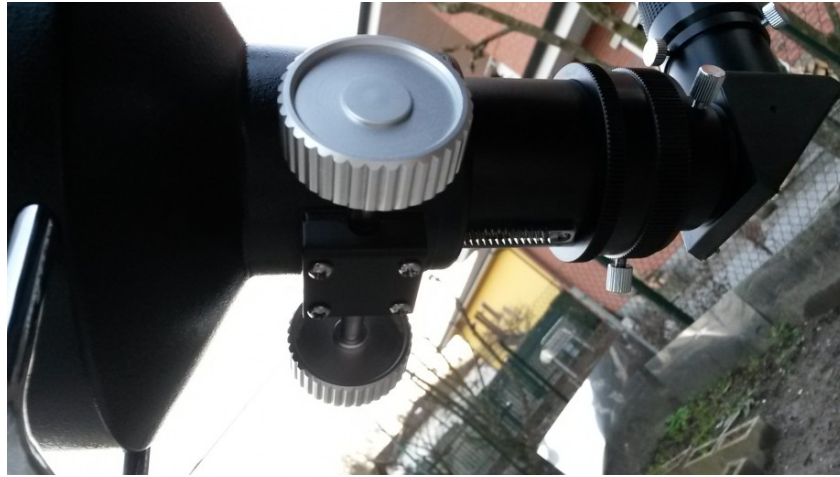
Figura 2: le quattro viti di regolazione del foceggiatore
