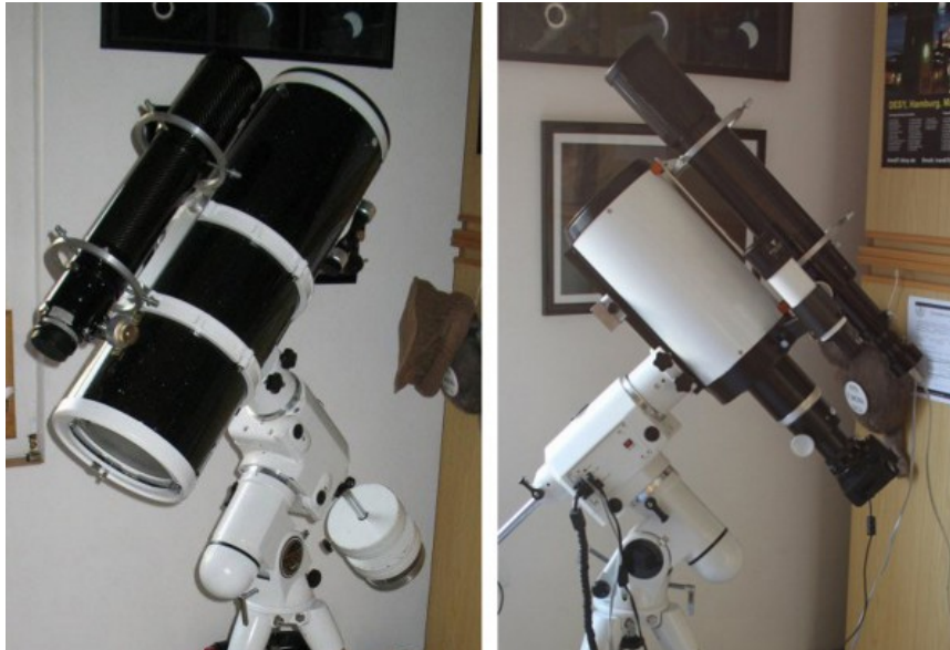
Figura 3.4: A sinistra esempio di telescopio riflettore Newton. A destra un esempio di telescopio Ritchey-Chrétien.
