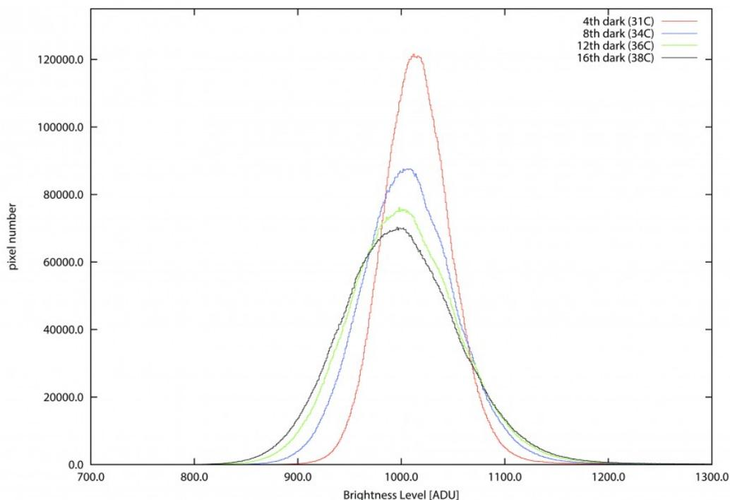
Figura 4: variazione della distribuzione dei livelli di luminosità del dark frame in funzione del numero di scatti successivi ossia della temperatura del sensore
