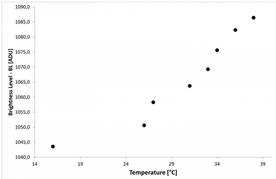
Figura 6: aumento del livello di luminosità media per pixel in funzione della temperatura del sensore per dark frame da 7 minuti a 800 ISO acquisiti in rapida successione.
