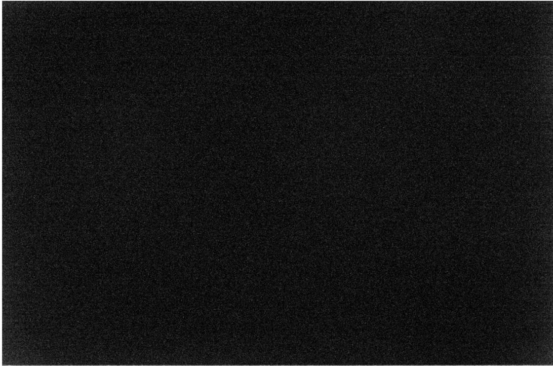
Figura 9: esempio di master dark frame acquisito con una DSLR modello Canon EOS 40D (sensore CMOS). E' possibile osservare i gradienti termici dovuti alle regioni del sensore più vicine a "punti caldi" dell'elettronica.
