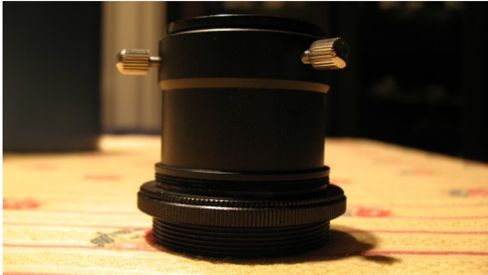
Figura 4 : il barilotto porta oculari
