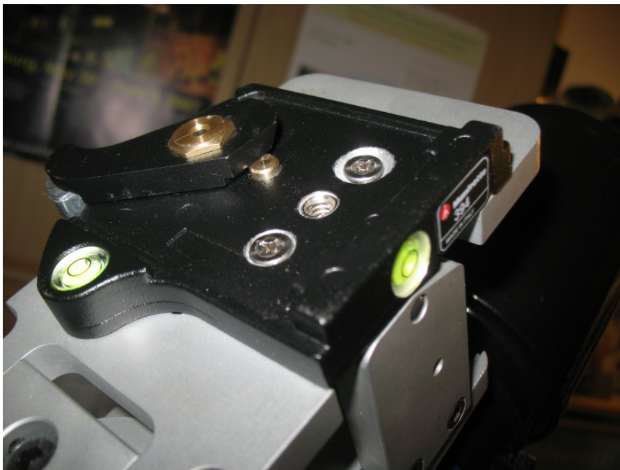
Il collegamento tra l'aggancio rapido Manfrotto 394 e la testa Geoptik GK2
